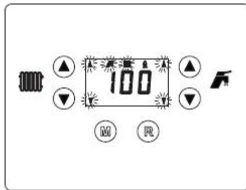
Рис. 17 – Режим ТЕСТ (мощность отопления – 100%)
