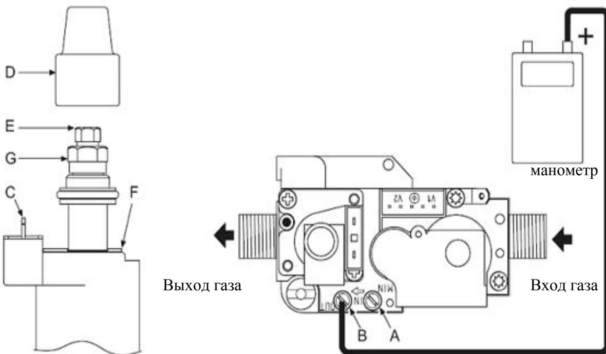
Рис. 19 газовый клапан
