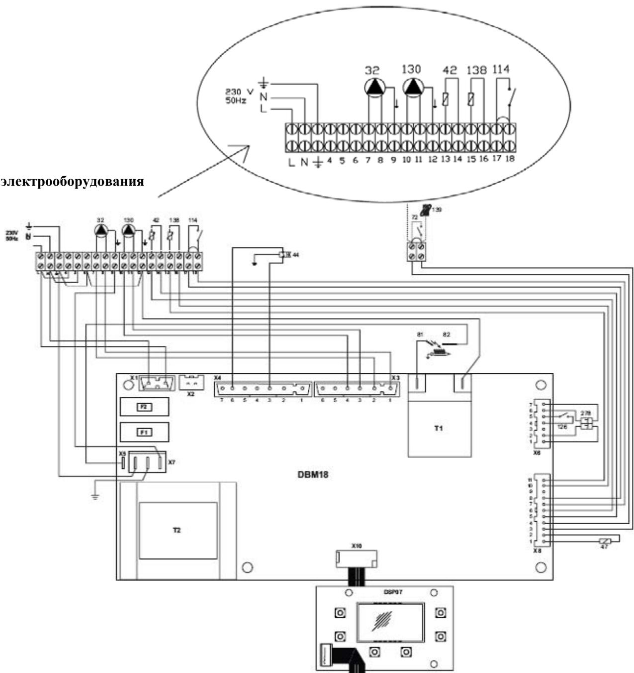
Рис. 24 – Схема электрооборудования
